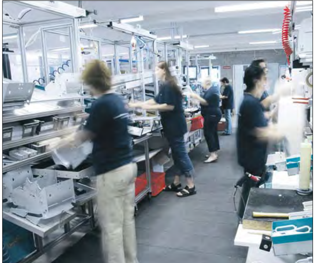
Heutige Montagelinie im «Einstückfluss-Prinzip».
